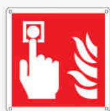
Allarme antincendio F005
